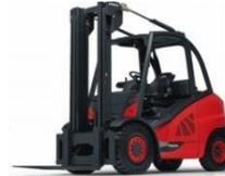
Chariot élévateur à mât muni de bras de fourche, sur lesquels la charge est placée en porte-à-faux par rapport aux roues et est équilibrée par la masse du chariot, dont la capacité nominale est inférieure ou égale à 6 tonnes.
