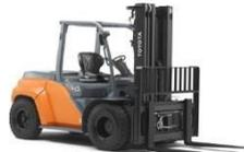
Chariot élévateur à mât muni de bras de fourche, sur lesquels la charge est placée en porte-à-faux par rapport aux roues et est équilibrée par la masse du chariot, dont la capacité nominale est supérieure à 6 tonnes.
