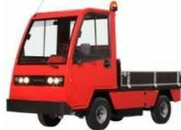
Chariot de manutention portant sa charge sur une plate-forme fixe ou sur un équipement non élévateur, dont la capacité de charge est inférieure ou égale à 2 tonnes.
